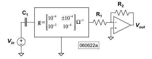
Nell'amplificatore di figura l'operazionale è ideale con guadagno infinito,  $R_1=10k\Omega$ ,  $R_2=50k\Omega$ ,  $C_1=1\mu F$ .
