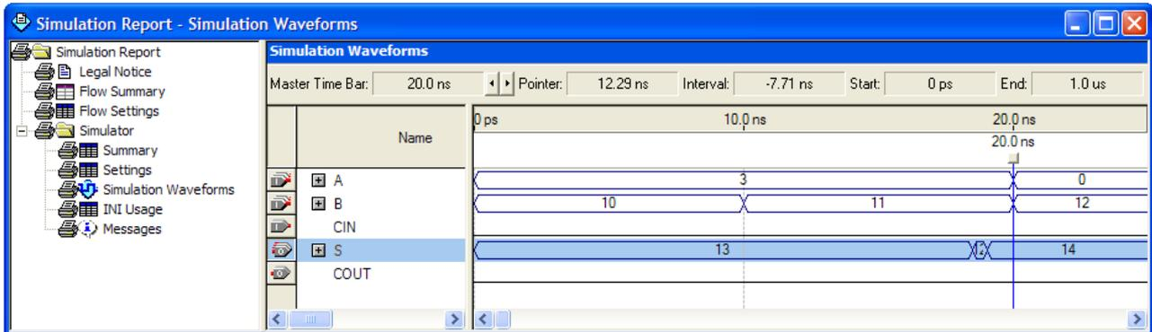
A differenza della simulazione funzionale, la simulazione tiene ora conto di tutti ritardi in gioco nel circuito. E’ pertanto evidente che rispetto alle forme d’onda viste nella simulazione funzionale, ove l’uscita commutava idealmente istantaneamente al variare degli ingressi, nella simulazione *Timing* l’uscita commuta e si stabilizza con un certo ritardo rispetto all’istante in cui variano i segnali d’ingresso.
