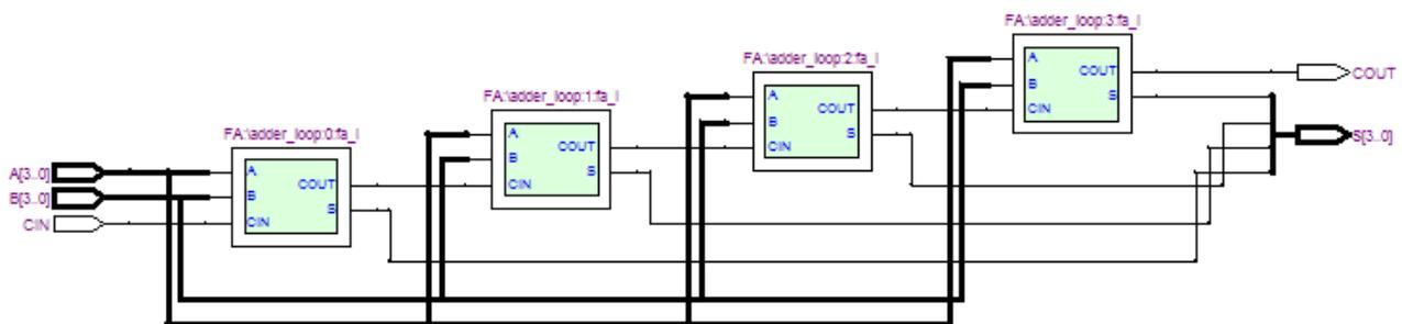
E' possibile inoltre esplorare la gerarchia e, per esempio, come ogni FA è internamente implementato. A tale scopo basta cliccare col tasto sinistro del mouse due volte su uno dei quattro FA per ottenere il seguente risultato, che mostra come ogni FA si compone di due HALF\_ADDER ed un OR:
