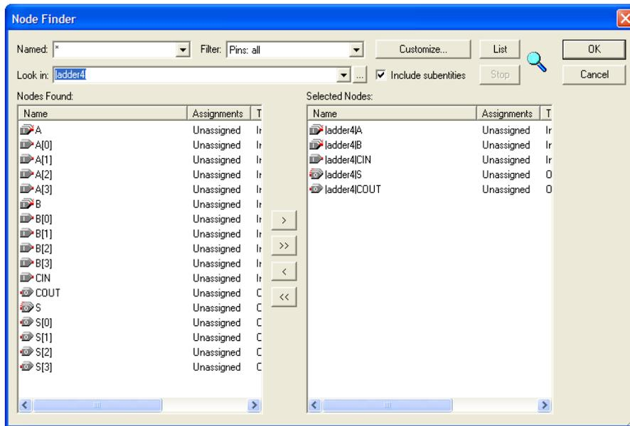
IMP: per i circuiti sequenziali è molto utile visualizzare l'uscita dei registri interni: per fare ciò (solo dopo avere eseguito il comando di generazione della netlist) dal node finder selezionare come filtro: **registers pre-synthesis**
