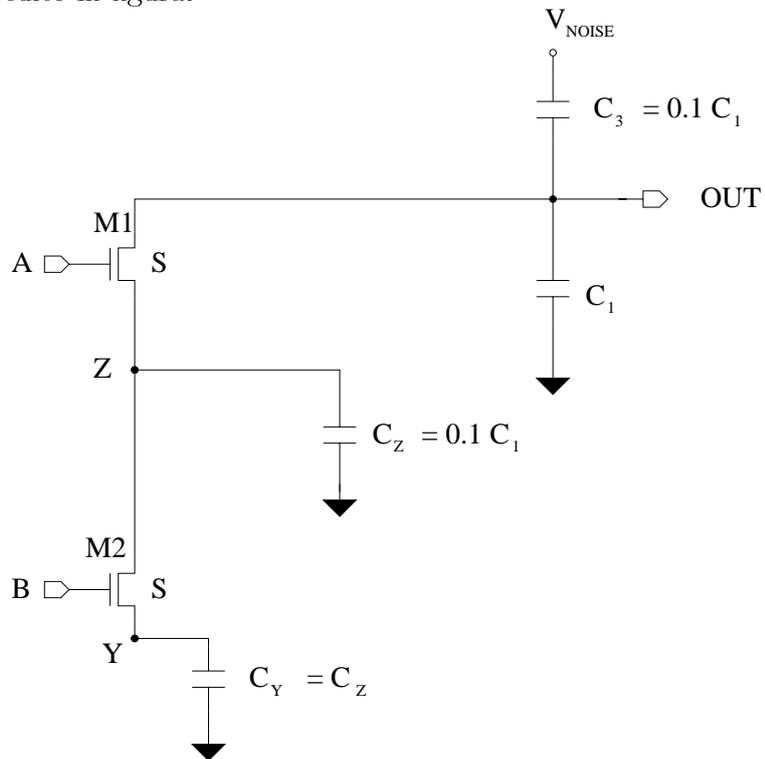
e assumendo le seguenti condizioni iniziali:  $V_{OUT} = V_{DD} = 2.5 \text{ V}$  e  $V_Z = V_Y = 0$ ,  $V_A = V_B = 0$  e  $V_{noise} = V_{DD} = 2.5 \text{ V}$  si calcoli il valore finale di tensione ai nodi  $Y, Z, OUT$  in seguito alla transizione di  $V_{noise}$  da  $2.5 \rightarrow 0$  **Si consideri**  $\gamma_n = 0$ .
