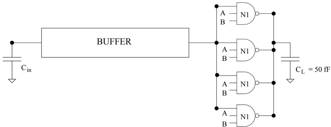
(a) Progettare (cio' e determinare il numero di stadi e il fattore di forma di ogni stadio) il buffer CMOS che minimizza il ritardo con cui viene caricata/scaricata la capacit' a che vede come carico . Si assuma  $C_{in} = 1.5fF$  e uguali in ogni stadio la durata dei transistori di carica e scarica.
